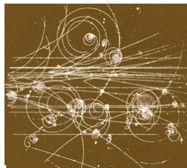
Во-вторых, с помощью магнитной силы Лоренца частицу можно значительно ускорить. Ведь для исследования взаимодействий микро-мира нужны высокоэнергетичные частицы.
