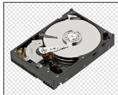
Принцип действия накопителей на магнитном носителе един. Магнитный слой накопителя делается из магнитно-мягкого ферромагнетика. Каждая единица информации (бит) имеет на носителе строго определенное положение (адрес). Этому адресу на носителе физически соответствует домен (или группа доменов) ферромагнетика. Домены эти могут быть
