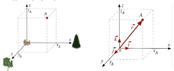
Ну а дальше понятно: в такой системе отсчёта положение точки A можно описать либо алгебраически как тройку чисел-координат  $(x_A, y_A, z_A)$  (координатный способ), либо геометрически как радиус-вектор, представимый через базисные единичные вектора и те же координаты:  $\overrightarrow{r} = x_A \cdot \overrightarrow{i} + y_A \cdot \overrightarrow{j} + z_A \cdot \overrightarrow{k}$  (векторный способ). Оба эти способа эквивалентны. Какой выбрать? По большому счету - это дело вкуса.
