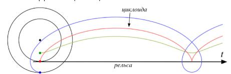
Точки катящегося колеса движутся по кривым, общее название которых - циклоиды<sup>19</sup>. Вот взгляниет на картинку - на ней показаны три циклоиды: красная - собственно циклоида - для точки, находящейся на ободе колеса, который катится без скольжения по оси; синяя -
