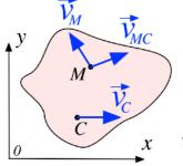
Скорость точки плоской фигуры равна векторной сумме скорости полюса (скорости поступательного движения) и скорости вращательного движения этой точки относительно полюса.
