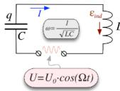
По закону Ома для полной цепи можем записать:  $\dot{\varepsilon}_{ind} = U_C + U_0 \cdot cos(\Omega t)$ или в уже ставшем привычном нам виде  $\ddot{q} + \frac{1}{LC} q = \frac{U_0}{L} \cdot cos(\Omega t)$ - получили дифференциальное уравнение,
