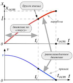
Вот что произойдёт: от 0 до времени  $t_1$  брусок будет двигаться по уравнениям [1] и [2] ("по синусу"), в момент  $t_1$  брусок полностью въедет на "трущуюся" поверхность, после чего он начнёт равнозамедленное движение до останова.
