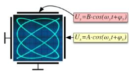
гармонически изменяющихся электрических полей и будет вырисовывать на экране фигуру Лиссажу. Вид её будет определяться соотношением частот  $\omega_x$  и  $\omega_y$ . Это позволяет точно подстроить частоту  $\omega_y$  под равную (кратную) частоте  $\omega_x$ : когда частоты становятся точно равными (или кратными) соответствующая  $\mathbf{3amkhytan}$  фигура Лиссажу на экране осциллографа замирает неподвижно. Когда частоты близки, но не равны, фигура
