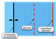
У плоской волны её фронты - это прямые (отрезки прямых), параллельные источнику. У радиальной волны - это концентрические окружности с центром на источнике колебаний. А передний фронт - это концентрическая окружность наибольшего радиуса.
