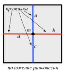
Пусть наш грузик m закреплён на четырёх пружинах внутри квадратной коробочки с гладким покрытием так, как это показано на рисунке (вид сверху). Картинка симметрична относительно осей.
