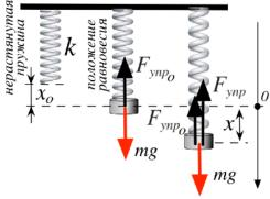
Сначала подвесим нерастянутую пружину жёскостью k. Теперь к пружине подвесим грузик массой m. Пружинный маятник собран! Под действием силы тяжести mg грузик растянет пружину на величину  $x_0$  относительно нерастянутого состояния. ПМ будет находиться в состоянии покоя - это его *положение равновесия*. При этом  $F_{ynp_0} = k \cdot x_0 = mg$  [a].
