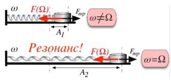
Вот иллюстрация. Вынужденные колебания пружинного маятника с трением (с собственной частотой  $\omega$ ) под действием вынуждающей силы  $F = F_0 \cdot cos(\Omega t)$ , где  $\Omega$  частота её изменения. Если  $\omega \neq \Omega$ , то амплитуда установившихся вынужденных колебаний равна  $A_1$ .
