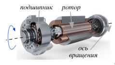
Вот ещё пример ситуации, когда резонанс может "натворить дел". У электродвигателя есть вращающийся ротор, закреплённый в подшипнике. Идеально центр тяжести ротора должен лежать точно на оси его вращения и эта ось должна совпадать с осью вращения подшипника. Но идеального ничего не бывает - существуют допуски при изготовлении роторов и подшипников. Наличие
