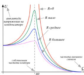
Как и в случае механических колебательных систем, резонанс в электрических описывается резонансными кривыми. Как видите, резонансное увеличение амплитуды тем резче, чем меньше электрическое сопротивление контура.
