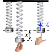
Начальные условия для колебаний ПМ задаются так же, как и для ММ: либо оттягиваем грузик и отпускаем его без начальной скоростии, либо "щёлкаем" по грузику в положении равновесия, сообщая ему начальную скорость, либо и то и другое одновременно.
