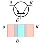
электронном ключе. А какие мы знаем электронные ключи? Правильно: ламповый триод или полупроводниковый транзистор. Будем рассматривать биполярный р-n-р транзистор в качестве ключа (хотя и триод и другие виды транзисторов тоже можно). Биполярный р-n-р транзистор - это два р-n-перехода и три электрода: коллектор, эмиттер и база. Током между эмиттером и коллектором можно управлять с помощью напряжения на базе. Обо всем об этом подробно рассказывалось в Истории про Ток.
