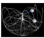
маятников различны и углы отклонения велики, поведение такого маятника описывается довольно сложной системой уравнений и может при определённых условиях переходить в хаотическое движение (как на фото).
