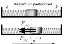
А вот каким ещё может быть пружинный маятник. Две одинаковые пружины закреплены одними своими концами к противоположным бортикам, а другими - к грузику массой m. Грузик может перемещаться по горизонтальной поверхности без трения.
