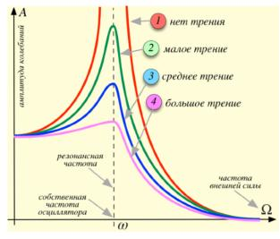
Зависимость амплитуды вынужденных колебаний от частоты вынуждающей силы называется резонансной характеристикой или резонансной кривой. Вот они показаны на рисунке.
