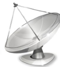
При передаче сигнала точечный излучатель, помещенный в фокус параболического зеркала, посылает сигнал, который, отразившись от стенок параболического зеркала, распространяется в параллельном луче по направлению к приемнику. Энергия сигнала не расплывается в окружающем пространстве, а сосредоточена в луче. Важную роль при этом играет точность наведения луча на приемник.
